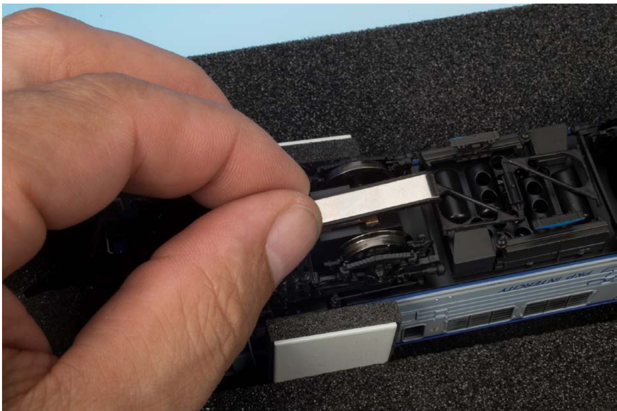
Abb. 6 Ziehe den Schleifer nun über das andere Ende der Federbronze, dabei kann man die eingefasste Seite ruhig etwas hochbiegen, da diese zurückfedert.
