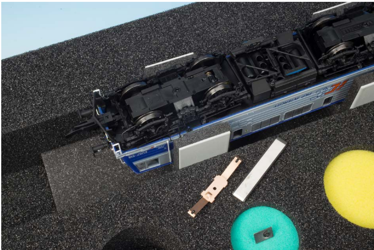
Abb.2 Nimm den Schleifer und ziehe diesen von der Federbronze ab, bevor du ihn einbaust.
