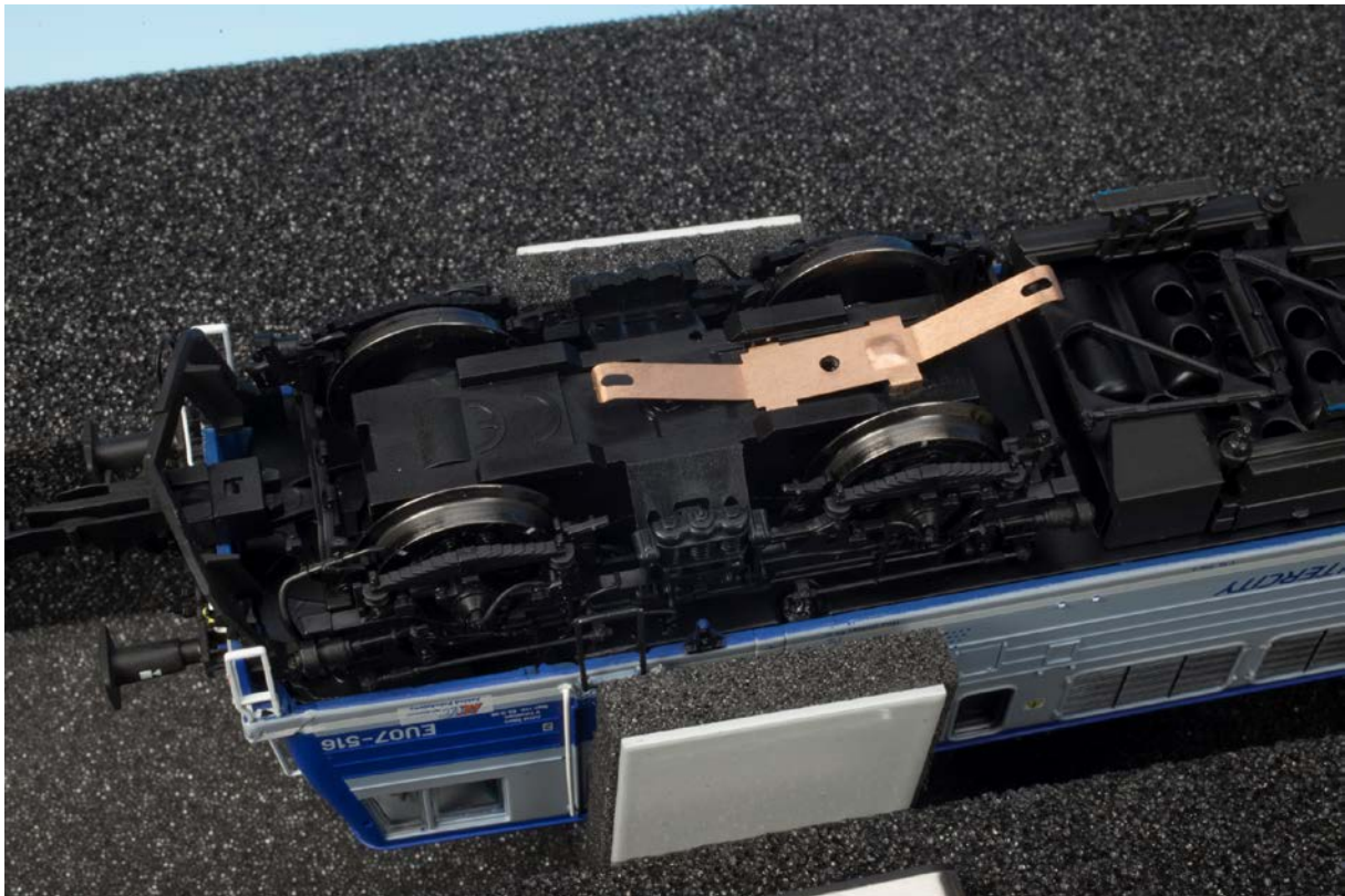
Abb. 3 Drücke die vier Halbleche der Federbronze in die dafür vorgesehenen Schlitze im Drehgestell
