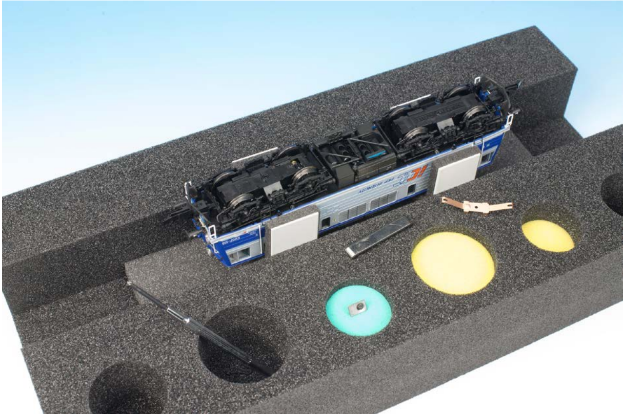
Abb.1 Das Drehgestell unter Kabine A ist für den Einbau des Schleifers werkseitig vorbereitet.
