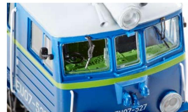
Ob Griffstangen, Signalthörner, Außenspiegel oder Scheibenwischer – die EU07-527 überzeugt mit zahlreichen angesetzten Feinheiten.
